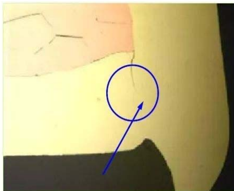
在端子底角处闭合的裂缝
